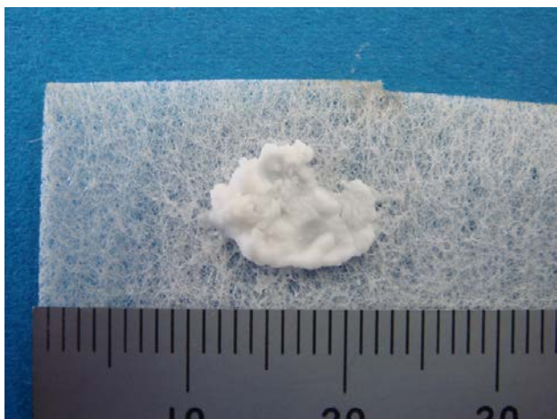
写真3 吸水シートに付着した状態の白い粉の固まり
