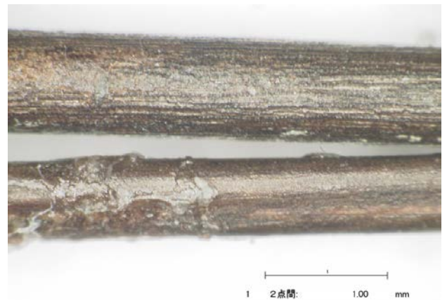
写真8 胚芽ごはん中の異物(下)と筍の繊維(上)のマイクロスコープ写真
